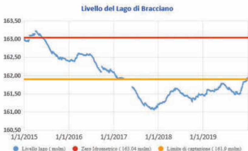
Figura 5 – Andamento idrometrico del livello del Lago di Bracciano.
